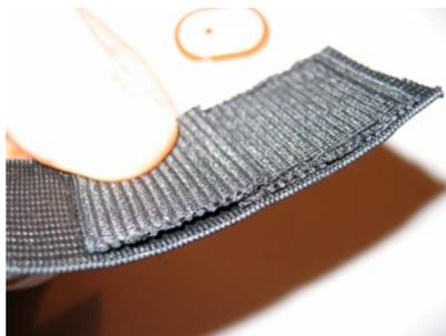
Positionnement de l'ensemble avec recouvrement sur 2 mm
